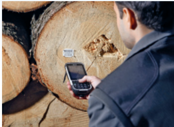
Digitale Poltererfassung mit mobilem Erfassungsgesamt direkt im Wald. Es werden Polterdaten inklusive Standortinformationen gescannt und auf Knopfdruck gespeichert.
